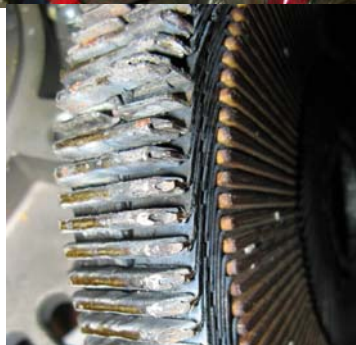
Lamelle de l'Induit du moteur d'un concurrent détruit
